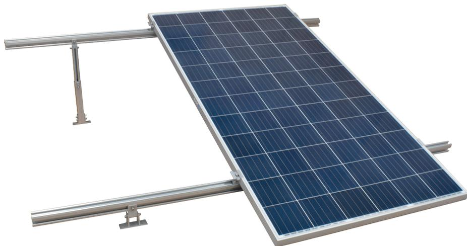
Estructura de montaje ajustable, diseñada para su fácil instalación, adaptable a las diferentes necesidades del sistema fotovoltaico con una garantía de 10 años. Está fabricada con materiales de alta calidad otorgando un plus en durabilidad y funcionalidad; extruido en aluminio 6005-T5 con un anodizado de 5 micras, beneficio que le permite instalarse en climas tropicales.
